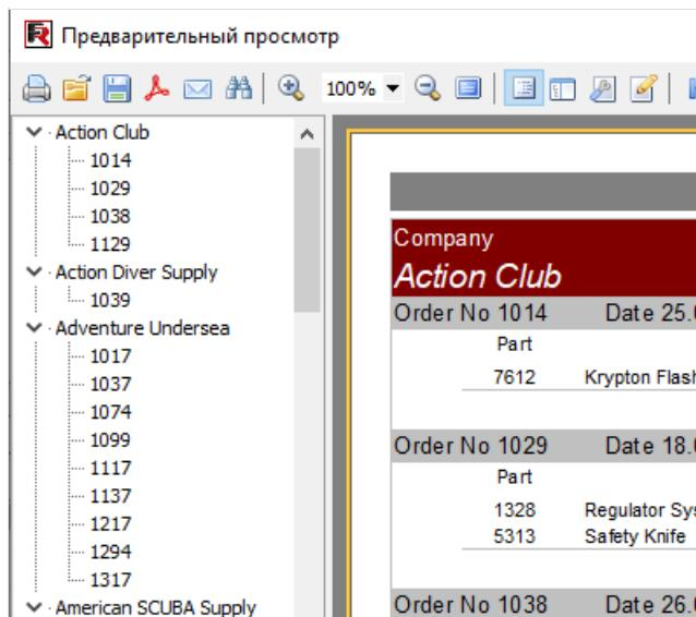
Этот элемент отображает древовидную структуру готового отчета. При щелчке на каком-либо узле дерева происходит переход на страницу отчета, связанную с этим узлом. Для отображения дерева нужно либо включить его кнопкой на панели инструментов окна предварительного просмотра, либо указать это в свойстве `Report.PreviewOptions.OutlineVisible` = True. Там же можно указать ширину элемента управления в пикселях: `Report.PreviewOptions.OutlineWidth`.
