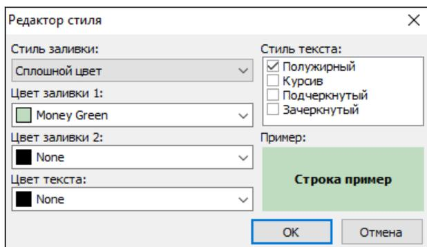
Редактор стиля позволяет выбрать вариант заливки фона, цвет и стиль текста. Для сплошной заливки достаточно задать только "Цвет заливки 1", а для градиентных заливок также требуется указать "Цвет заливки 2".
