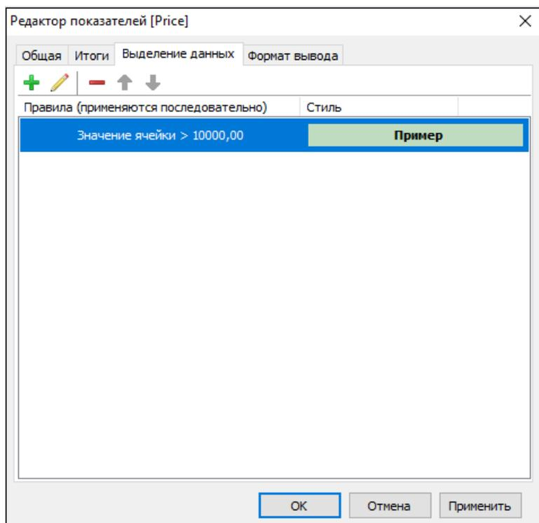
Правило выделения позволяет обрабатывать значения показателей как значения, текст, даты, а также как NULL. В зависимости от вида обработки можно применять различные варианты условий. Так, например, для обработки значений можно использовать операции "больше", "меньше", а для текстовой обработки доступны операции вхождения или невхождения подстроки в строку ("содержит", "не содержит").
