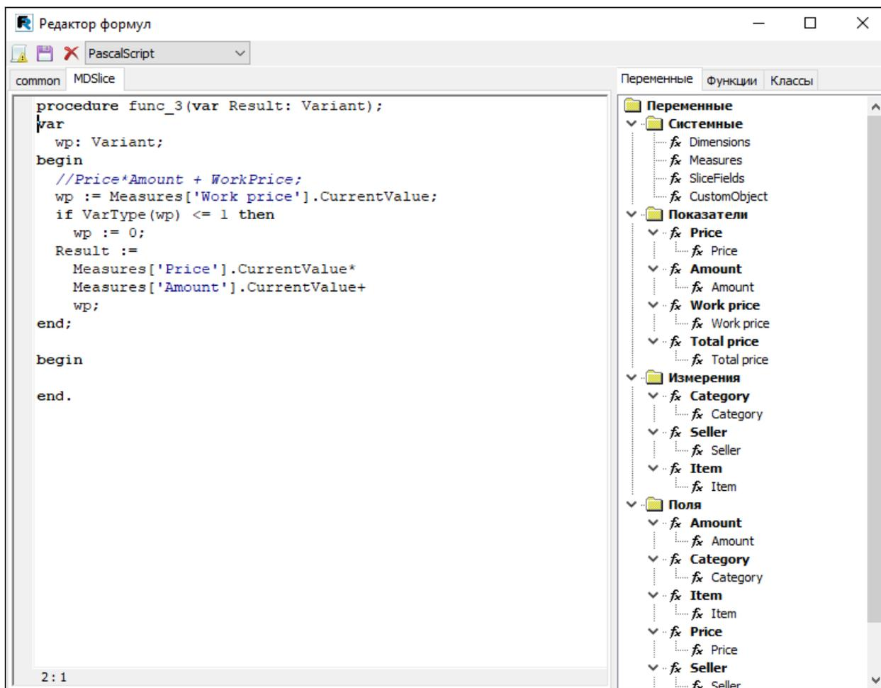
Функция для расчета показателей на основе других показателей вызывается по одному разу для каждой ячейки (пересечения измерений). Если не установлен параметр "Вычислять все ячейки", то для пустых ячеек вызов функции не производится.
